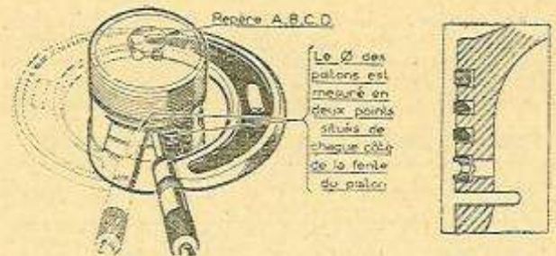
Fig. 10. — Repérage des pistons. Fig. 11. — Orientation des segments.
