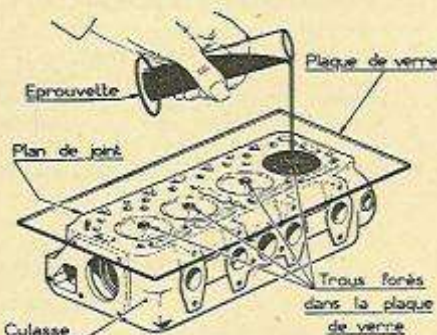
Fig. 90. — Contrôle du volume des chambres dans la culasse.
